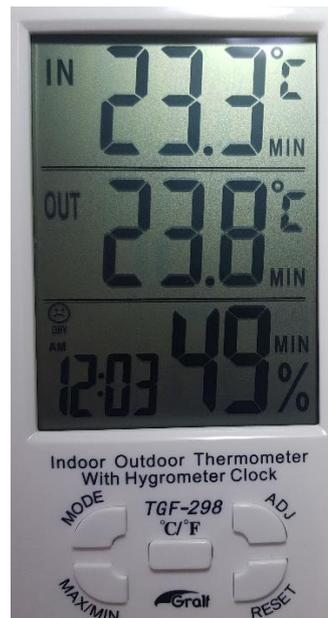
Cuando se encuentre en MAX/MIN presione el botón RESET una vez para limpiar un valor máximo o mínimo previamente memorizado, para volver a medir otros.
